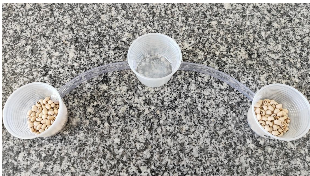
Figura 5 - Arena de teste de repelência composta por três recipientes interligados, contendo grãos de feijão-caupi tratados e não tratados, utilizada para avaliar a preferência ou evasão de C. maculatus .
