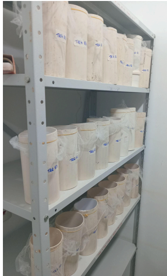
Figura 5. Recipientes contendo os casais de Chrysoperla externa por tratamento e repetição, utilizados na fase crônica após 120 horas de exposição no sistema ASPECLE. Sobrevivência e oviposição foram avaliadas aos 6, 11, 16 e 21 dias.
