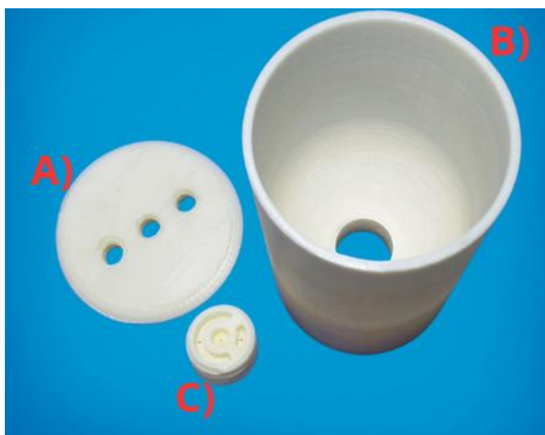
Figura 2. Célula eletroquímica composta em: A) tampa com orifícios, B) copo reservatório e C) suporte de eletrodos.
