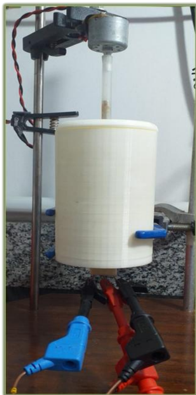
Figura 4: Imagem mostrando a montagem do sistema eletroanalítico.
