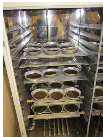
Figura 11. Estufa de circulação forçada utilizada para secagem das amostras
