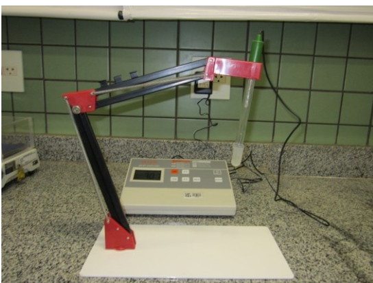
Figura 10. Phmetro de bancada utilizado para as determinações
