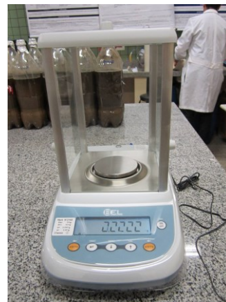
Figura 9. Balança de precisão utilizada para as determinações
