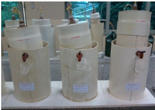
Figura 3. Disposição dos biodigestores na bancada do laboratório.
