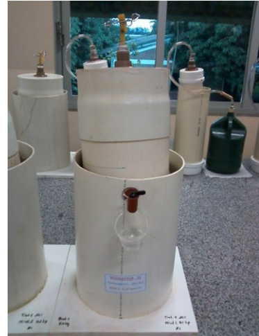
Figura 2. Biodigestor batelada utilizado no experimento
