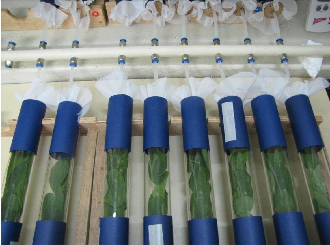
**Apêndice 6** – Gaiolas de contato contendo folhas tratadas com pesticidas e conectadas ao sistema de ventilação.
