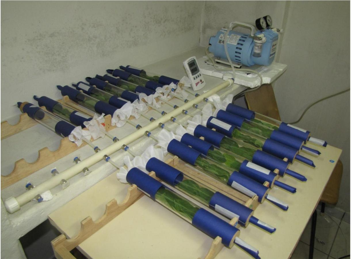
**Apêndice 1** – Componentes do sistema de ventilação (bomba de vácuo, tubo central e mangueiras) utilizado para impedir a formação de gases tóxicos no interior das gaiolas de exposição.
