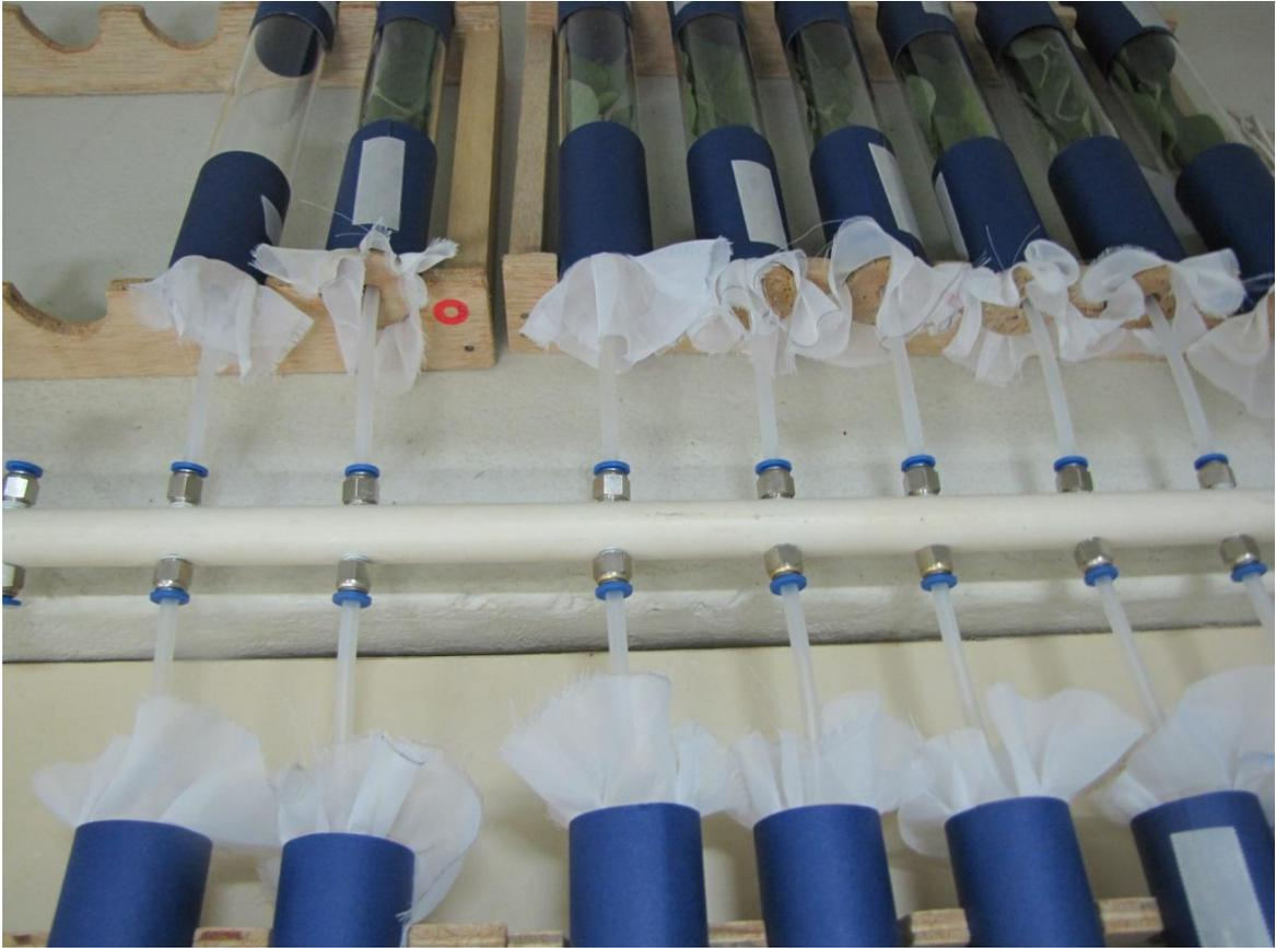
**Apêndice 3** – Sistema de ventilação: detalhe da conexão das gaiolas com tubo central.
