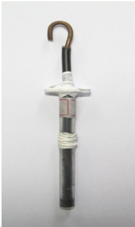
Figura 14. Foto do eletrodo de pasta de carbono modificado.
