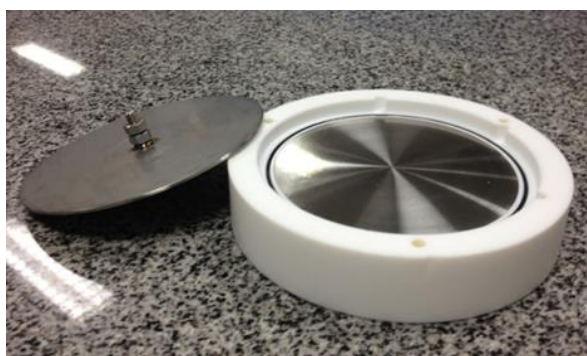
Figura 13 - Célula de medidas utilizada no estudo elétrico tanto para medidas AC quanto DC e esquema representativo mostrando o fator geométrico da célula: onde A é a área, e h é a distância entre os eletrodos.
