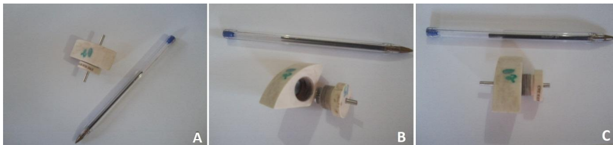
Figura 7. Célula eletroquímica utilizada nas análises de impedância. A) Estágio fechado. B) Estágio aberto. C) Estágio semi-aberto.
